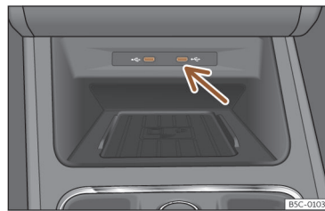
Fig. 163 Centre console: USB input.
